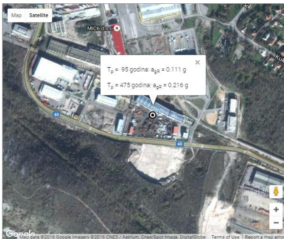
Slika 6. Horizontalna vršna ubrzanja tla tipa A ( a_{gR} ) za povratna razdoblja od T_p = 95 i 475 godina za lokaciju tvrtke Metis d.d.Podružnica Kukuljanovo
